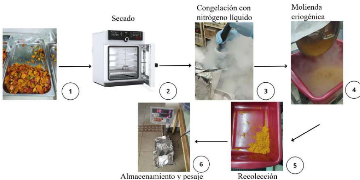
Figura 3. Esquema ilustrativo del tratamiento de la materia prima.
