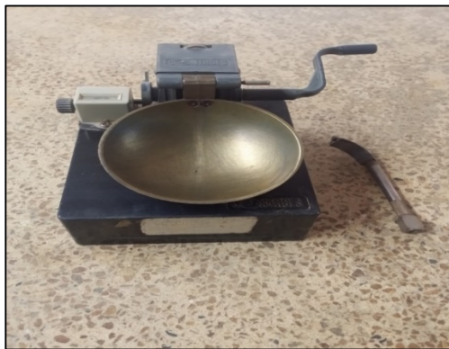
Figura 4.3 Cazuela de Casagrande y ranurador estándar. Laboratorio de Suelos y Pavimentos, EICG.
