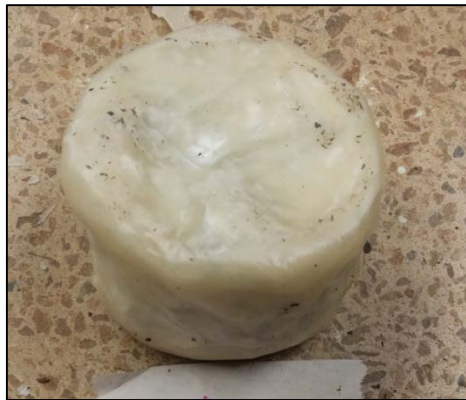
Figura 4.1 Muestra parafinada para ensayo de peso unitario
