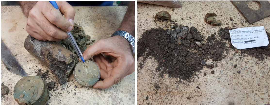
Figura 5.1 Presencia de escombros y material grueso en las muestras del sondeo #4. Laboratorio de Suelos y Pavimentos, EICG
