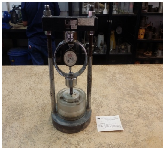
Figura 4.5 Ensayo de potencial de expansión en el aparato de Lambe. Laboratorio de Suelos y Pavimentos, EICG.
