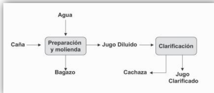
Figura 1.3. Origen del bagazo y cachaza en el proceso de fabricación del azúcar
