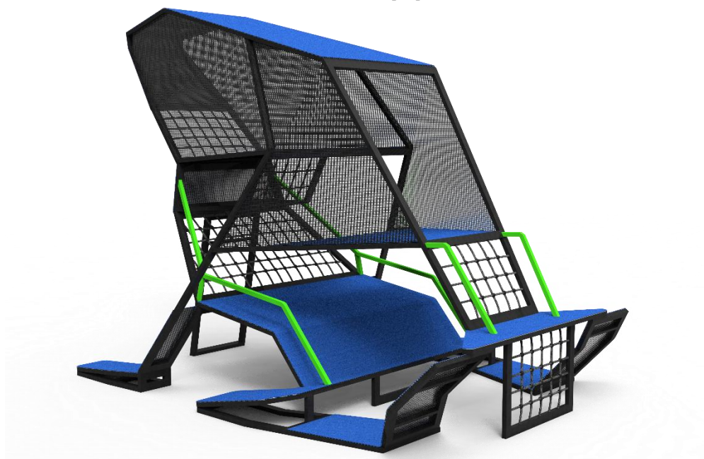
Figura 124: Nivel uno y dos, barandas de seguridad. Fuente: Datos propios.
