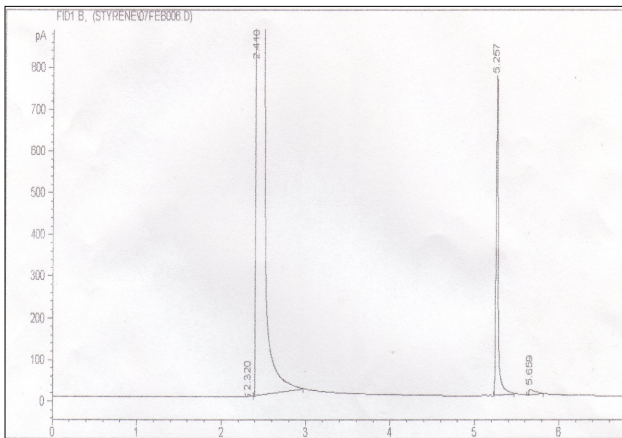
Figura 5. Análisis por cromatografía de gases para la hidroformilación de estireno en presencia del complejo catalítico [\text{Rh}(\text{COD})(+)(\text{DIOP})]^+ . Relación \text{H}_2/\text{CO} 1:1.
