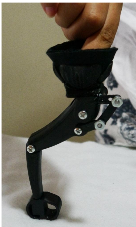
Figura 52. Prótesis con todas las piezas ensambladas
