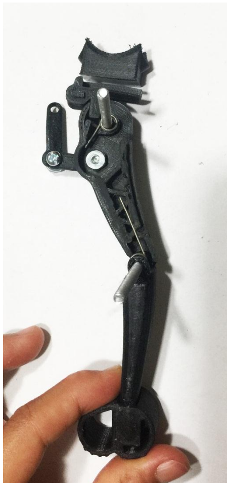
Figura 50. Ubicación de los resortes de torsión en la prótesis
