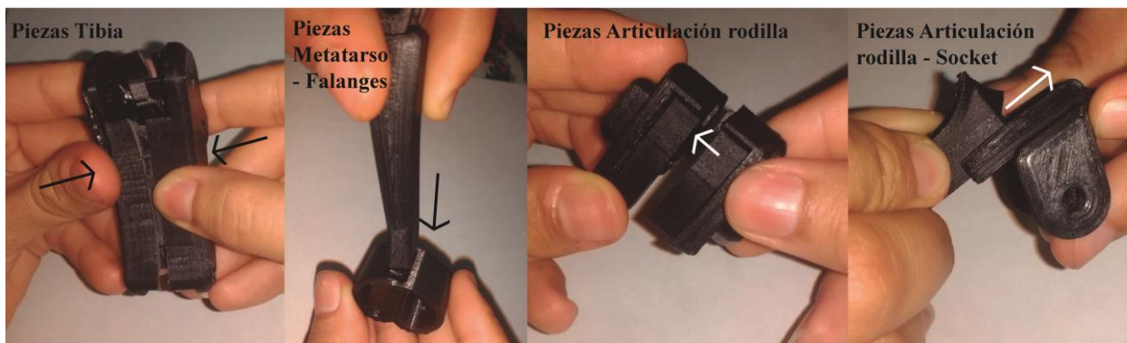
Figura 51. Mecanismos de ensamble de las piezas que componen la prótesis
