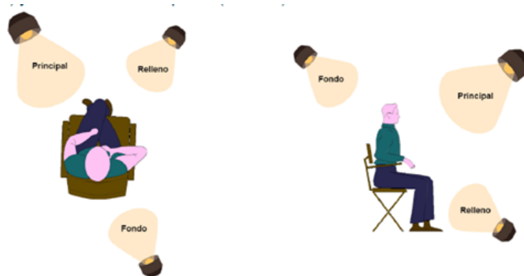
Figura 25. Esquema de iluminación de tres puntos.
