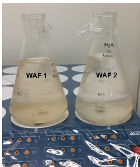
Figura 9. Mezcla sedimento-agua reconstituida en proceso de agitación magnética
