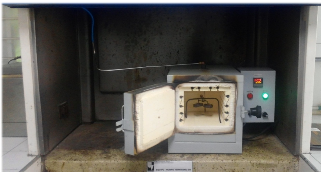
Figura 9. Montaje experimental usado durante las pruebas de sulfatación de las calizas.
