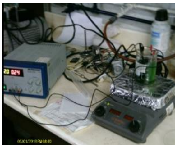
Ilustración 7 Celda conectada a la fuente DC
