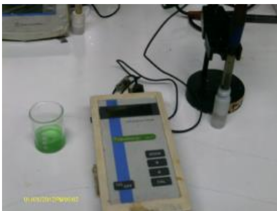
Ilustración 8 Medición del pH de la Solución
