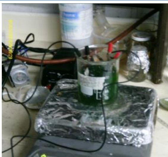
Ilustración 6 Montaje de la Solución con Níquel Negro
