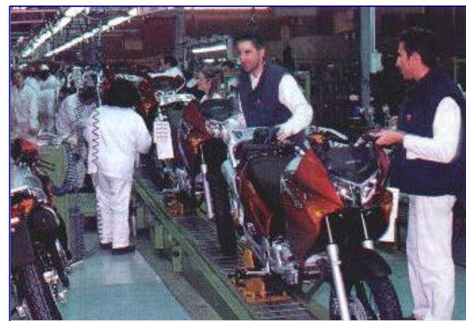
Sistema de ensamble motos Honda. España. Sistema automático de arrastre con cadena y motor reductor.
