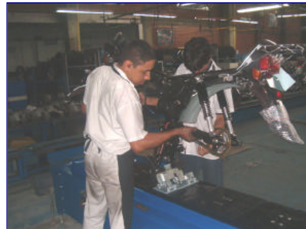
Sistema de ensamble motos Honda. Colombia. Sistema automático de arrastre con cadena y motor reductor protección del material placas en empack.
