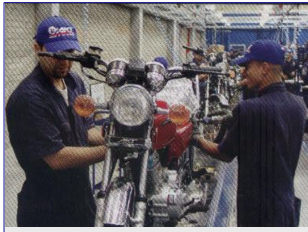
Sistema de ensamble motos Akt. Colombia. Sistema automático de arrastre con cadena y motor reductor.
