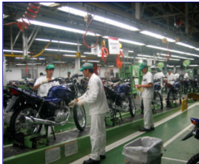
Sistema de ensamble motos Honda Amazonia. Brasil. Sistema automático de arrastre con foso, cadena y motor reductor.
