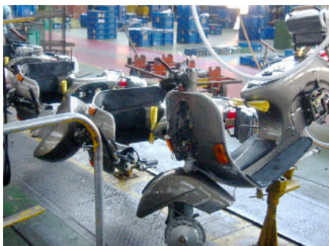
Sistema de ensamble Genuine Scooter Company. EU. Sistema automático de arrastre con soporte moto giratorio, cadena y motor reductor.
