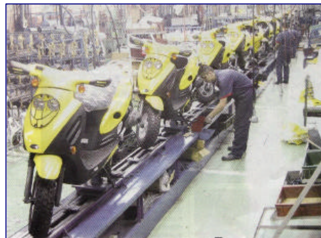
Sistema de ensamble motos Auteco. Colombia. Sistema automático de arrastre con cadena y motor reductor.
