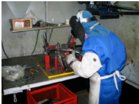
Los tipos de soldadura más utilizados en este proceso son: MIG, TIG, Punto, Proyección y Costura.
