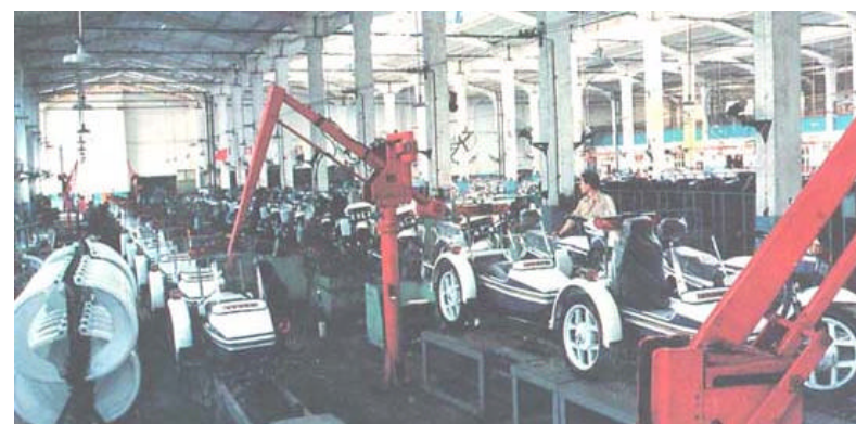
Sistema de ensamble Hiimage. Nueva Zelanda. Sistema automático de arrastre de cadena con plataforma para ensamble, similar automóviles con motor reductor.
