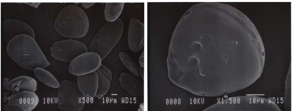
Figura 6.16. Microfotografías de almidón hidroxipropilado de achira HP20
