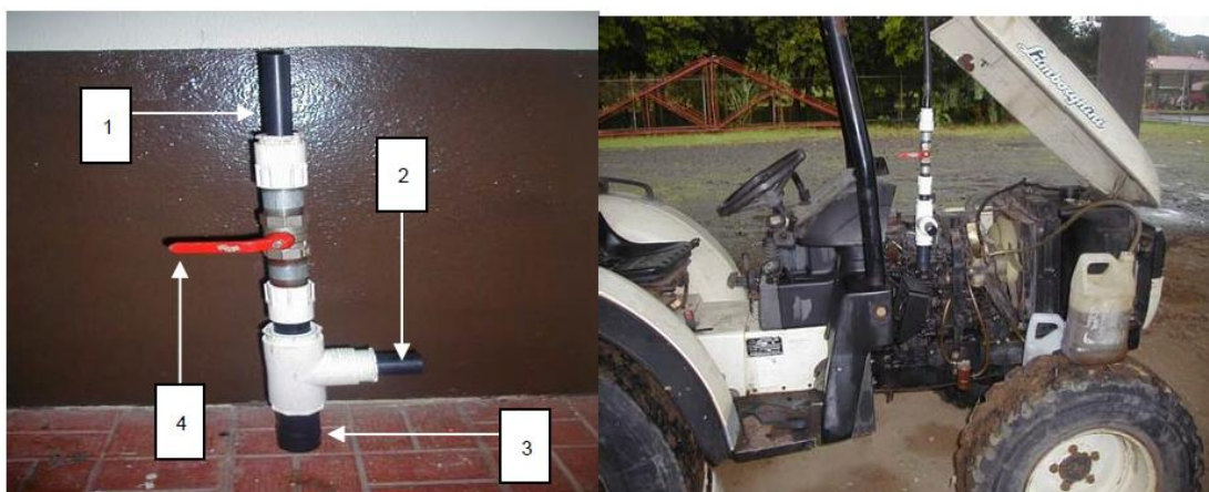
Figura 20. Artefacto y motor diésel modificado para funcionar con biogás [16].
