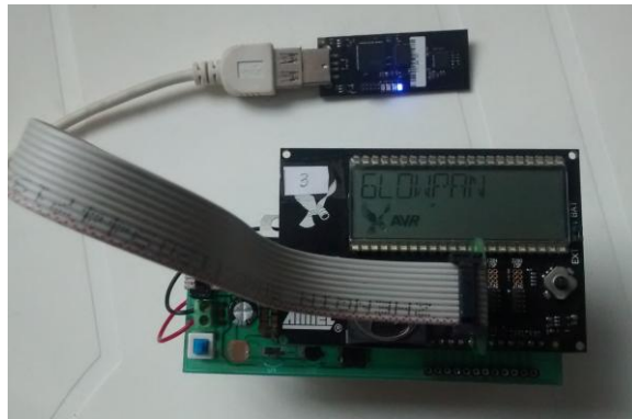
Figura 5.11: AVR-RAVEN en Nodo Sensor y USBstick Jackdaw
