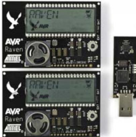
Figura 3.1: Nodo Sensores y Jakdaw (usbstick) [19]
