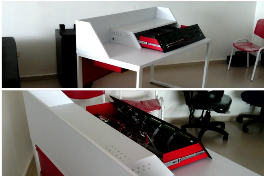
Figura 58. Montaje de la caja de conexiones
