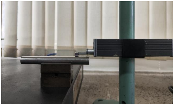
Figura 44. Prueba de rugosidad
