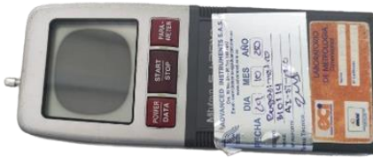
Figura 43. Rugosímetro Mitutoyo SJ-201P
