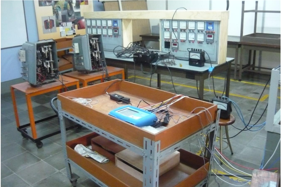
Figura 25. Circuito de prueba mostrando resistencias y registrador PX5
