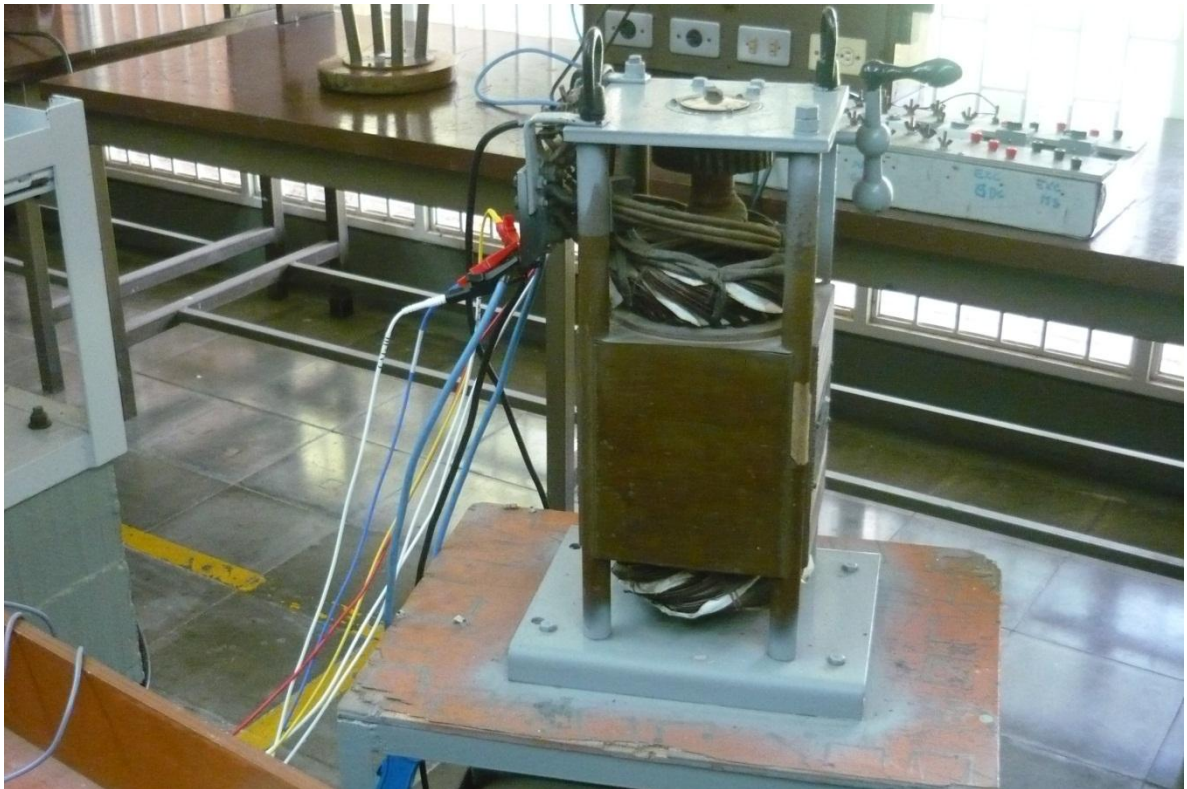
Figura 24. Vista del circuito de prueba del variac y guardamotor.
