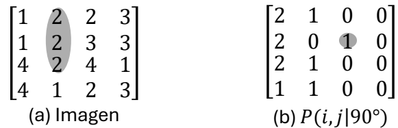
Figure 2.8: Construcción de una GLRLM. Niveles de gris originales (a) y matriz GLRLM para la dirección vertical m = (0, 1) , donde se ha sombreado el elemento (2, 3) que señala 1 carrera de longitud 3 con niveles de gris 2 en la dirección vertical de la imagen original (b).
