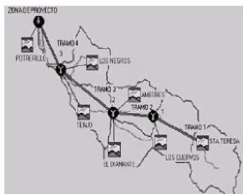
Figura 2. Esquemización de la modelación hidrológica del Río Nima.
