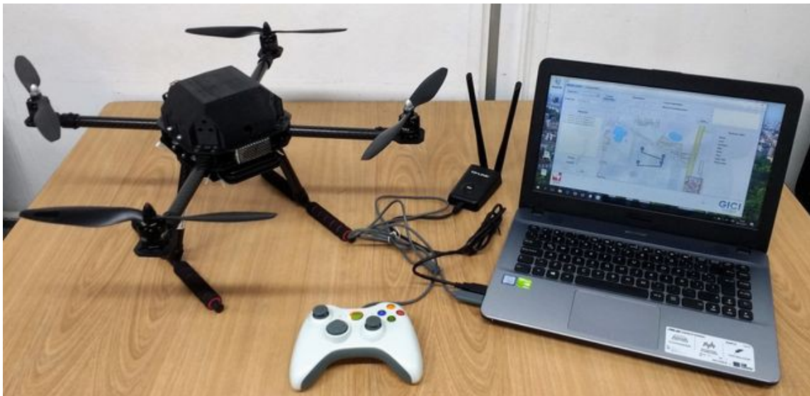
Figura 2. Sistema de vuelo para cada cuadricóptero.
