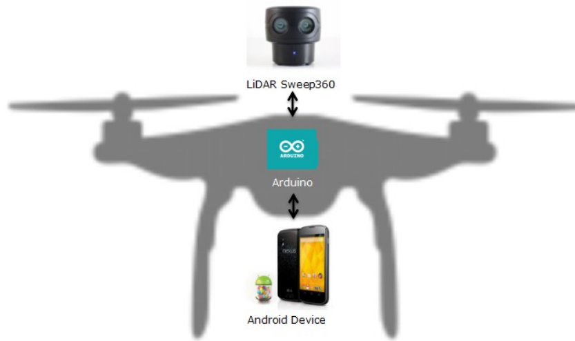
Figura 6. Estructura general GALS integrado con el cuadricóptero.
