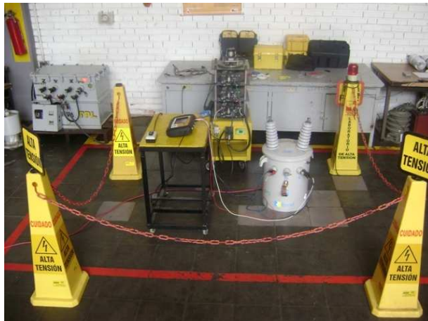
Figura 12. Montaje ensayo pérdidas bajo carga y tensión de corto circuito.
