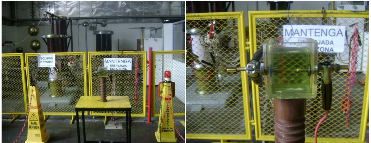
Figura 16. Montaje tensión tipo impulso a muestra de aceite.
