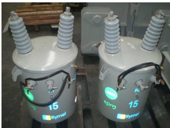
Figura 6. Transformadores bajo estudio y su implementación de los sensores.
