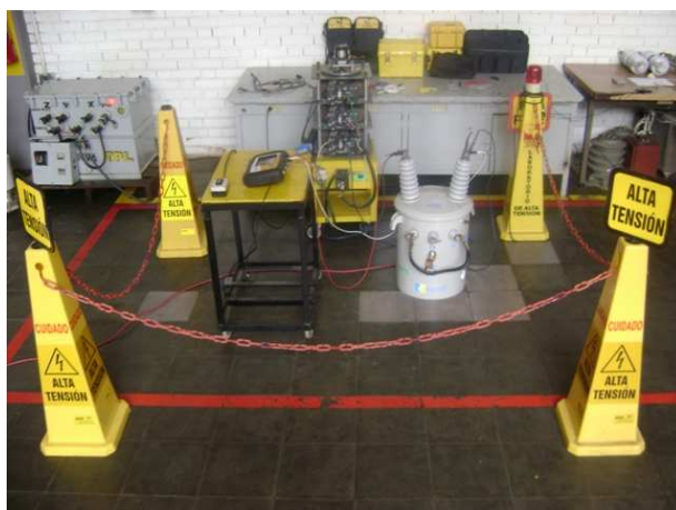
Figura 12. Montaje ensayo pérdidas bajo carga y tensión de corto circuito.
