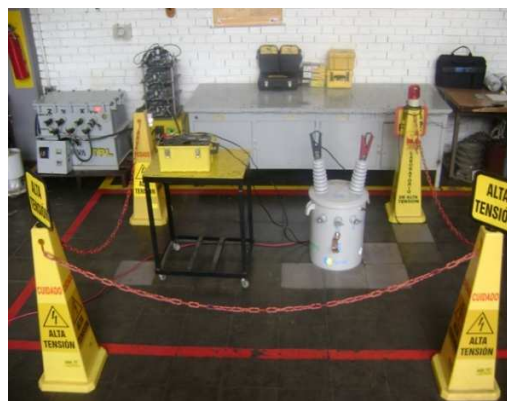
Figura 9. Montaje ensayo resistencia de devanados.
