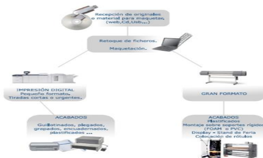
Ilustración 9. Flujo del proceso de producción de un producto de impresión digital genérico Fuente: tomado de Tintas y Soporte, S.L. Valencia España.
