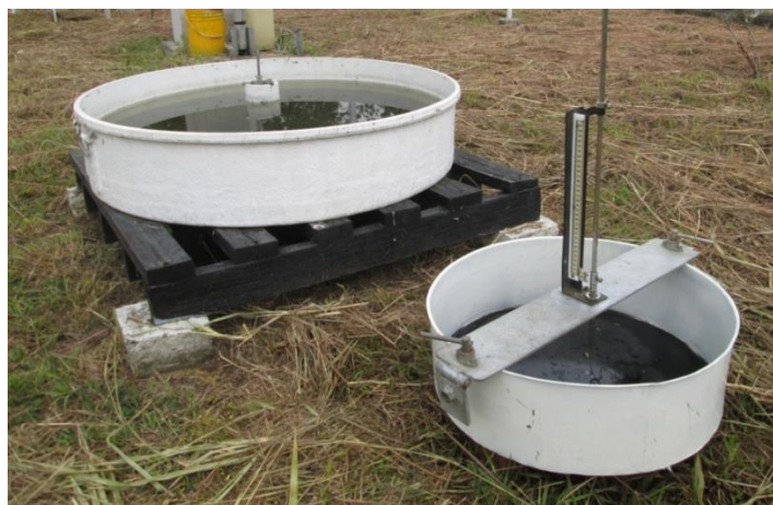
Figura 6. Tanque evaporímetro de la estación meteorológica (izquierda) y tanque prototipo (derecha).
