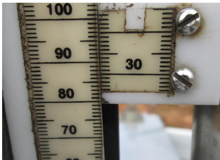
Figura 7. Regla milimetrada incorporada en el limnómetro de gancho.
