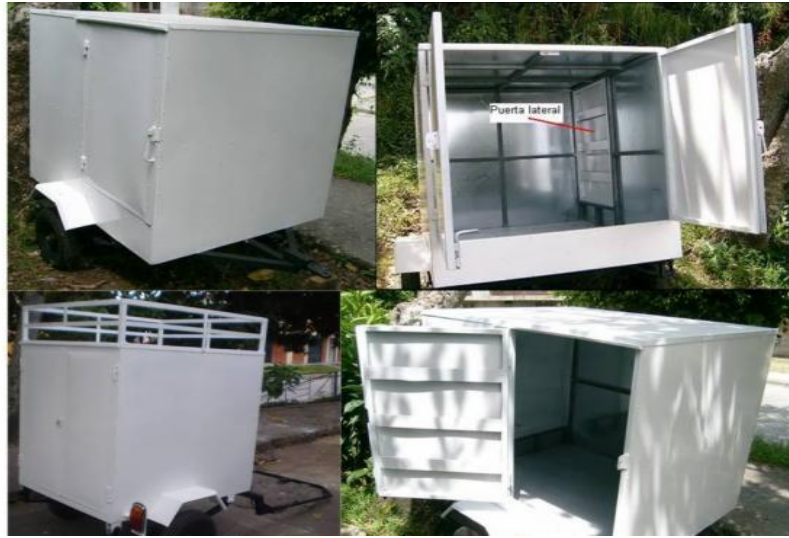
Figura 2. Tráiler para moto en fibra de vidrio, totalmente cubierto
