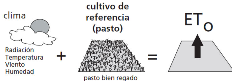
Figura 4. Esquema de la Evapotranspiración del cultivo de referencia ( ET_0 ). Fuente: Allen et al. (2006)
