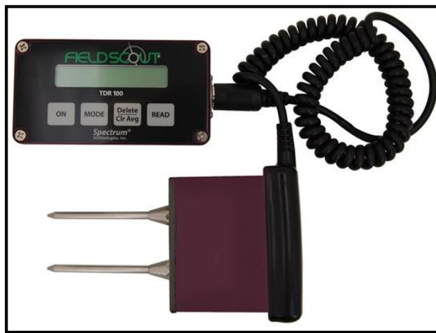
Figura 11. Sonda TDR. Fuente: www.sbk-mexico.com
