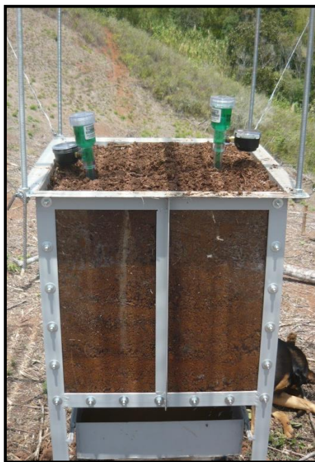
Figura 20. Tensiómetros instalados en el lisímetro
