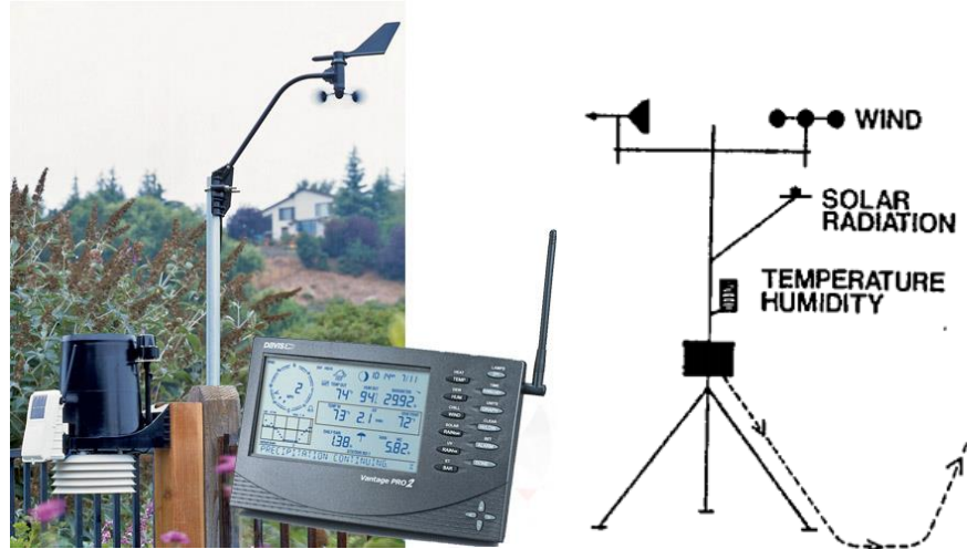
Figura 29. Esquema de una estación climatológica portátil. Fuente: http://ag.arizona.edu/pubs/water/az1194.pdf
