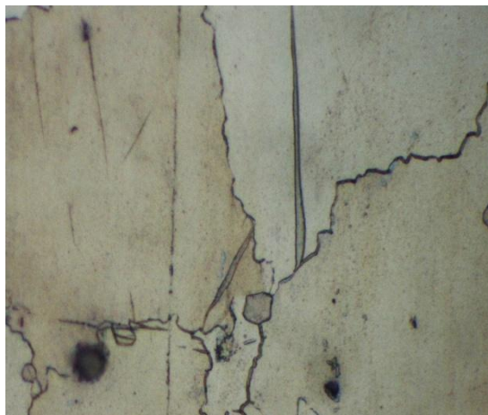
Figura 34. Microestructura: Zona termicamente afectada, 500x.
