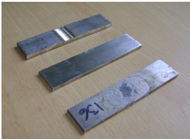
Figura 16. Probetas soldada, pulida y después del ensayo electroquímico.
