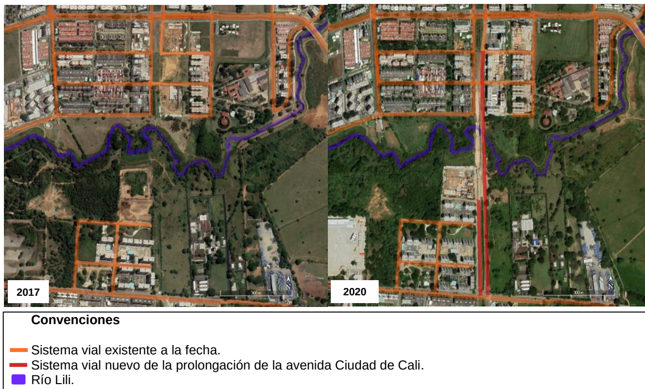
Imagen N°2. Aerofotografías de la prolongación de la avenida Ciudad de Cali sobre el río Lili.
