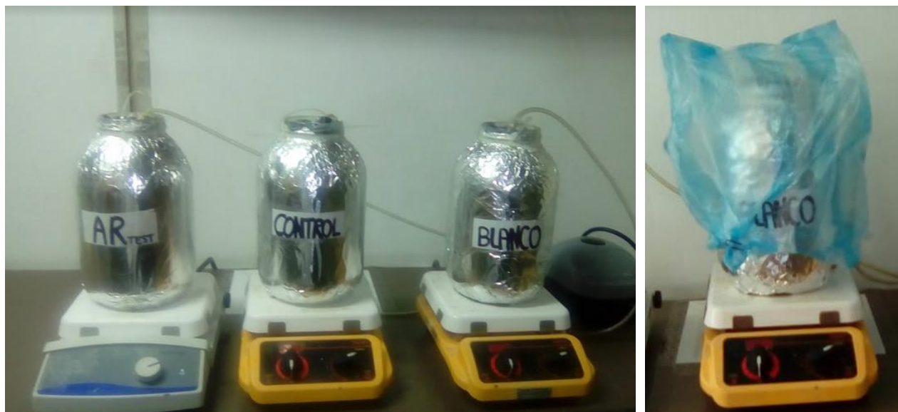
Figura 19. Reactores para el montaje del ensayo de biodegradabilidad del AR real
