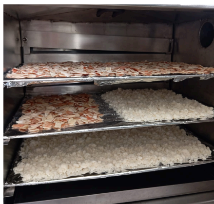
Figura 1. Secado de la cáscara y bagazo de yuca en un horno de convección forzada.
