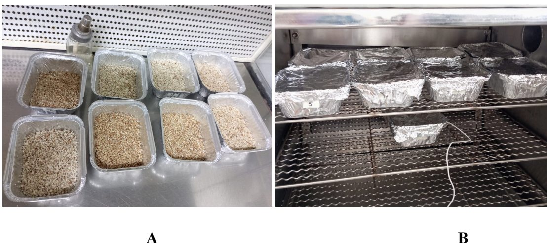
Figura 4. Montaje experimental fermentación en estado sólido. Nota. (A) Bandejas listas para fermentación. (B) Bandejas listas para iniciar el proceso de fermentación. Fotografía tomada por la autora, elaboración propia.
