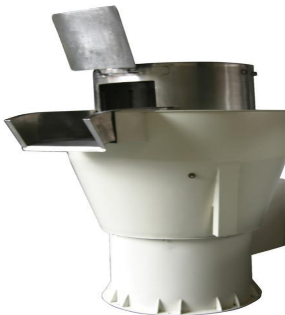
Imagen 4 Máquina lavadora de panzas, librillos y cuajos
