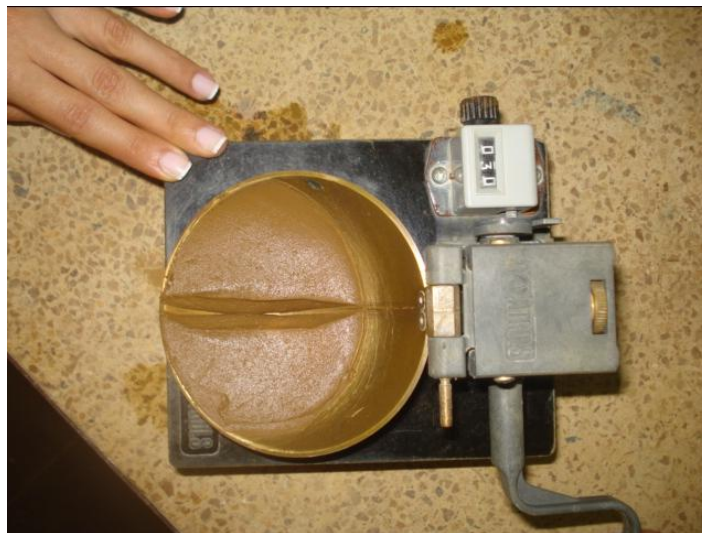
Fotografía 11. Prueba límite líquido.
