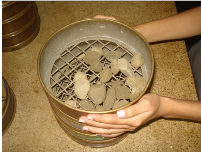
Fotografía 10. Prueba de granulometría por tamizado
