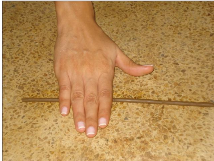
Fotografía 12. Prueba límite plástico.
