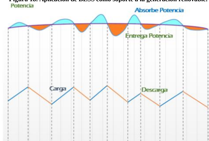
Figura 18. Aplicación de BESS como soporte a la generación renovable.
