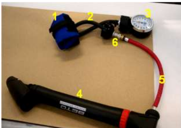
Figura 11. Dispositivo para inducción de isquemia. 1: Brazalete con cubierta en tela kodra y centro de caucho sintético. 2: mangueras de conexión al manómetro y a la bomba de insuflación manual. 3: Manómetro. 4: Bomba de insuflación. 5: Extensión de adaptación para la bomba. 6: Válvula de retención de aire.
