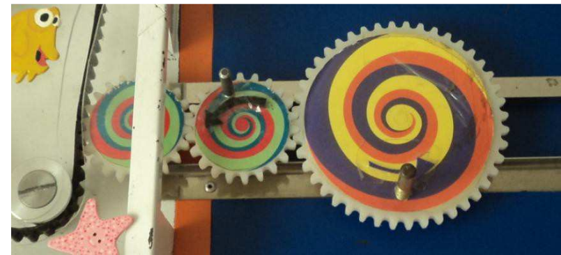
Figura 17. Cadena - Engranaje mediano final y dos engranajes móviles concatenados
