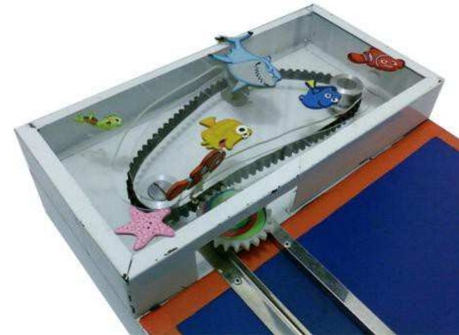
Figura 14. Zona de los personajes – la cadena dentada y engranaje fijo
