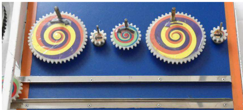
Figura 18. Dirección de giro de los engranajes
