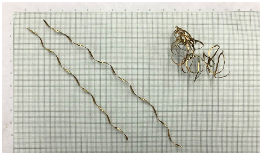
Figura 20 Virutas obtenidas con una herramienta de corte desgastada, material 13Cr-4Ni.
