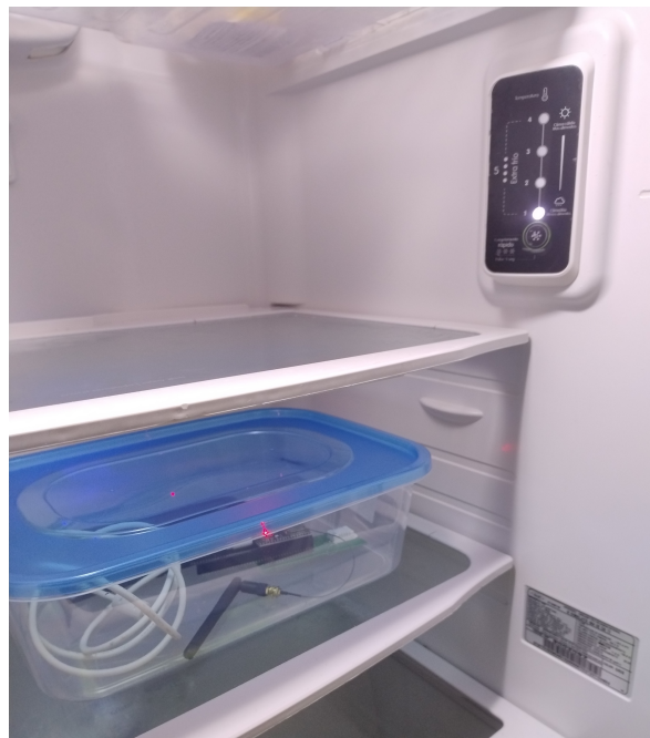
Figura 5.1. Montaje del escenario favorable: sensor dentro del refrigerador.
