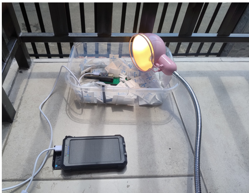
Figura 5.5. Montaje del escenario desfavorable: sensor expuesto al sol, fuente de calor y gel de sílice.
