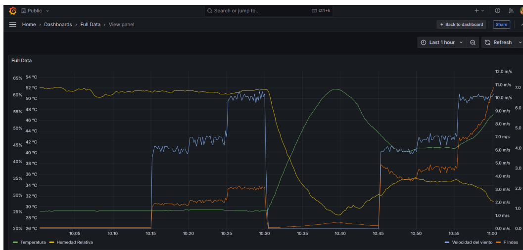
Figura 5.6. Registro de temperatura, humedad relativa, velocidad del viento e índice F en Grafana durante el escenario desfavorable.
