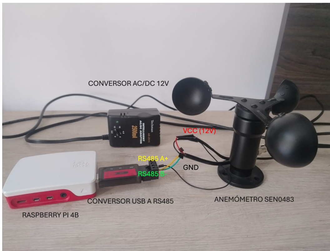
Figura 4.4. Conexión del anemómetro RS485 (DFRobot SEN0483) a la Raspberry Pi mediante convertor RS485-USB y fuente de 12 V.
