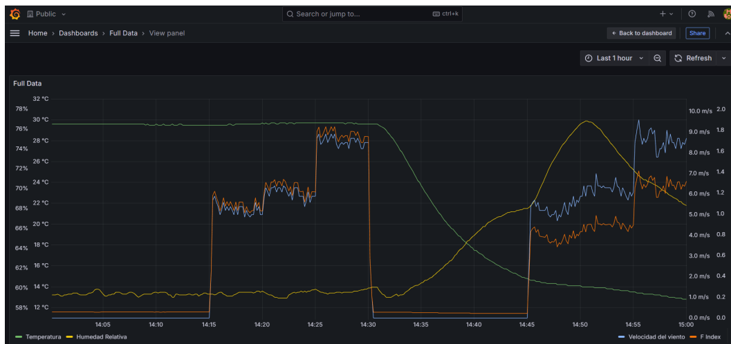
Figura 5.2. Registro de temperatura, humedad relativa, velocidad del viento e índice F en Grafana durante el escenario favorable.
