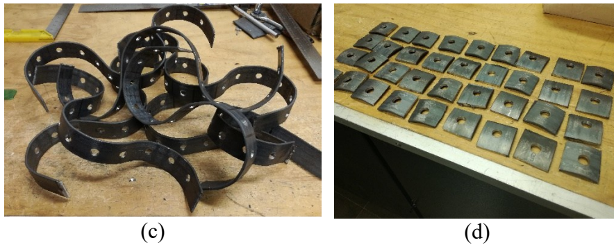
Figura 3.4. Fabricación de platinas curvas (a) perforación de cada sección, (b)-(c) curvado de platinas y (d) resultado final.
