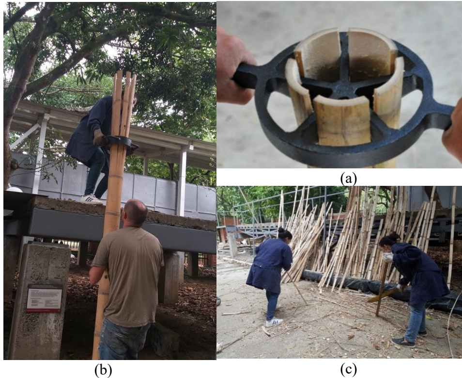
Figura 3.2. Corte de culmos de guadua en latas. (a) Estrella, (b) paso de la estrella y (c) pulimiento de las latas.
