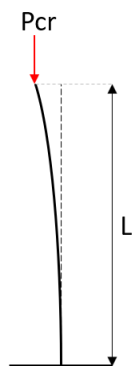
Figura 2.5. Columna en condición libre – empotrada.
