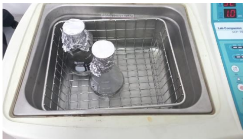
Figura 8.6. Fotografía de dos Erlenmeyer con soluciones de PCL y MWCNT, respectivamente, dentro del equipo de ultrasonido.
