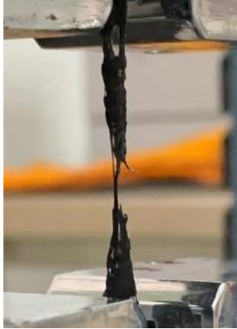
Figura 9.39. Fractura de una probeta del andamio de PCL (C) /MWCNT al 3%, con forma de hilo
