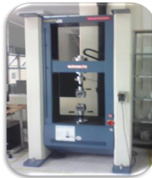
Figura 8.19. Fotografía de la máquina de Ensayo Universal TINIUS OLSEN H50Ks (ubicada en Tenoparques SENA-ASTIN).
