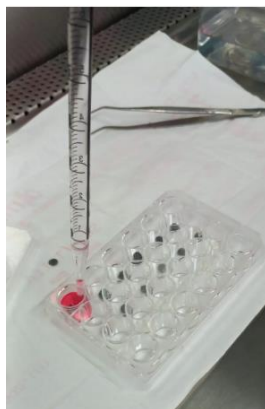
Figura 8.36. Colocación de 2 mL de CM a los pozos con los andamios de PCL (c) /MWCNT.
