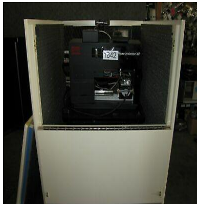
Figura 8.15. Equipo de nanoindentación utilizado en los andamios de PCL/MWCNT (equipo ubicado en ingeniería de materiales, universidad del Valle)
