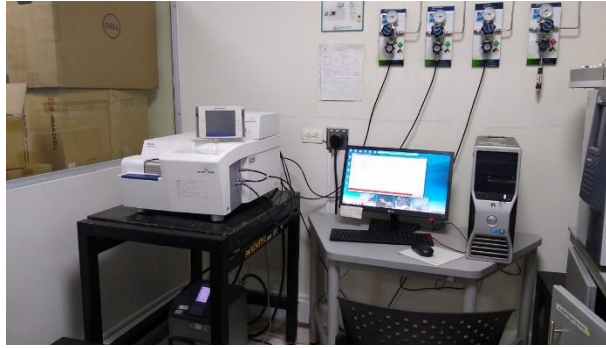
Figura 8.14. Fotografía del equipo de TGA marca Mettler Toledo (ubicado en Tecnoparque SENA-ASTIN)
