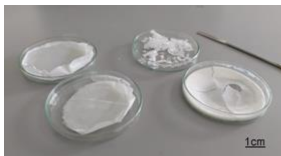
Figura 9.1. Síntesis de PCL de alto peso molecular obtenida mediante el mecanismo de coordinación-inserción.
