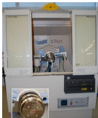
Figura 8.12. Difractómetro de Rayos-X de referencia PANalytical X'pert proTM (ubicado en el departamento de física Universidad del Valle)
