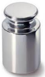
Figura 8.46. Imagen masa de 50 g especial para la calibración, realizado en el laboratorio de fisiología, de la Universidad del Valle
