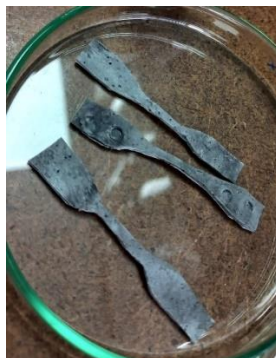
Figura 8.20. Fotografía ilustrando el aspecto de las probetas de PCL/MWCNT de acuerdo con la norma ASTM D638-14.
