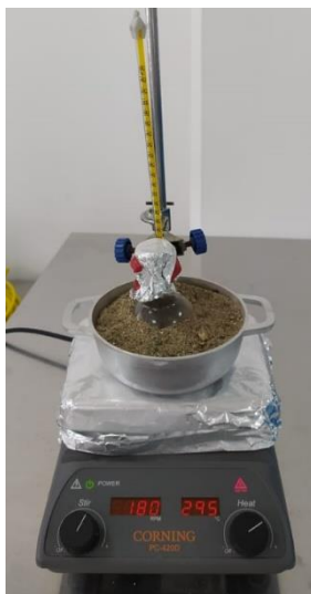
Figura 8.1. Montaje de la polimerización de la PCL. Se observa el balón inmerso en la arena para mantener homogénea la temperatura.
