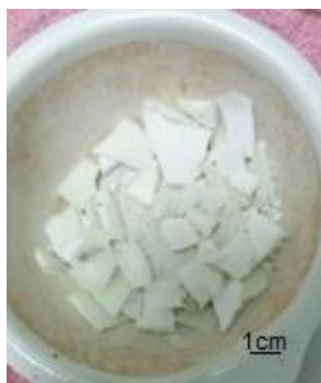
Figura 9.2. PCL de alto peso molecular obtenida por el mecanismo de coordinación-inserción siendo macerada en mortero.
