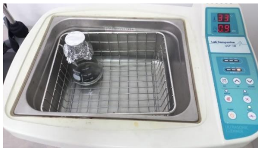
Figura 8.5. Fotografía del equipo de ultrasonido con un Erlenmeyer en su interior, que contiene MWCNT disueltos en cloroformo.
