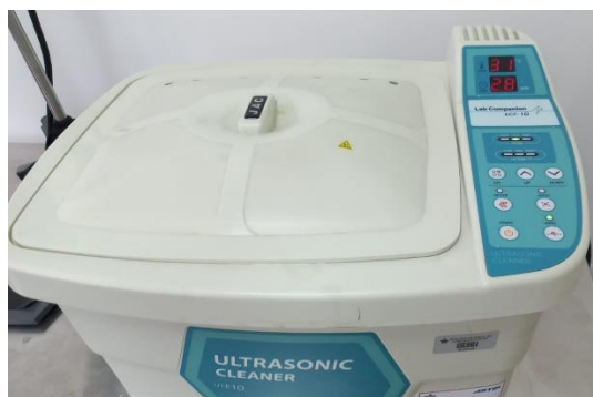
Figura 8.4. Fotografía del equipo de ultrasonido empleado para lograr el acople de MWCNT/PCL (Equipo Ubicado en tecnoacademia SENA-ASTIN)
