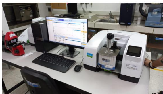
Figura 8.9. Fotografía del equipo de FT-IR marca Perkin Elmer Spectrum IR 10.7.2 (equipo ubicado en el SENA ASTIN)
