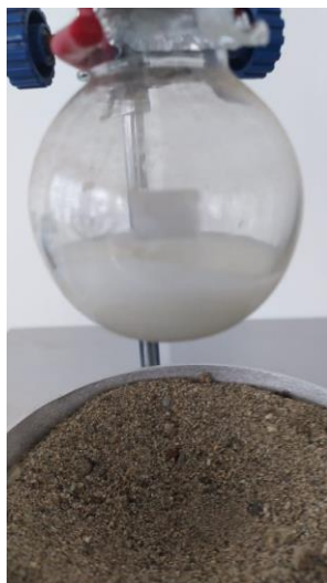
Figura 8.2. Aspecto del balón con PCL sólida blanca de alto peso molecular.
