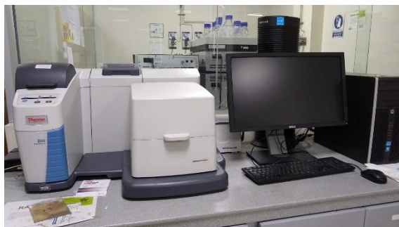
Figura 8.8 Fotografía del equipo de espectroscopia RAMAN marca, ThermoScientific (Equipo ubicado en Tecnoparque SENA ASTIN).
