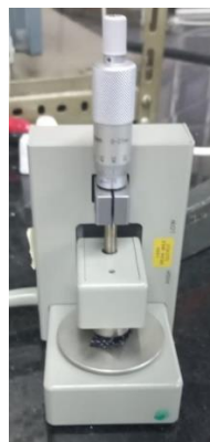
Figura 8.23. Porta muestras para medir la impedancia eléctrica del material (ubicado en el departamento de Física de la Universidad del Valle)
