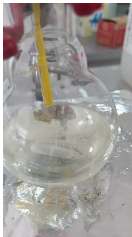
Figura 8.3. Fotografía del balón con PCL obtenida después del calentamiento a 140°C por 48 h, el reposo hasta temperatura ambiente y la disolución con cloroformo.
