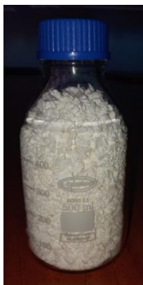
Figura 9.3. PCL sintetizada por ROP, empacada en un frasco de vidrio de 1000 mL.
