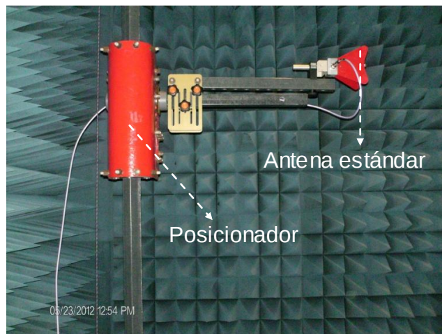
Figura 34. Antena estándar tipo corneta
