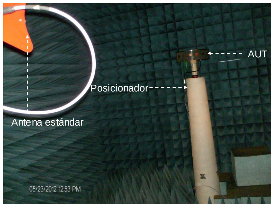
Figura 33. Montaje de pruebas patrón de radiación
