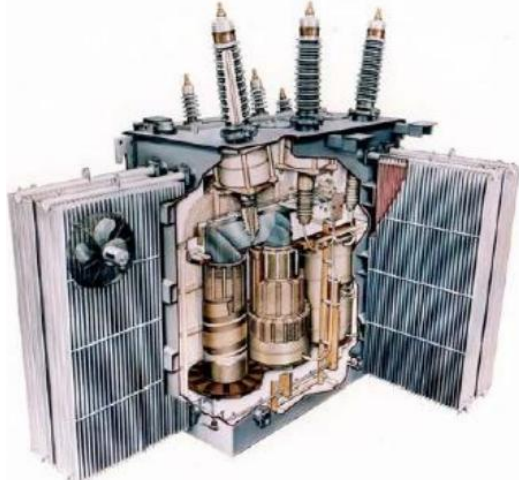
Figura 2: Transformador con vista de sus aislamientos internos.
