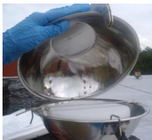
Figura 5. Espuma de poliuretano TE-1014 ubicada en el muestreador de aire y sostenida por la barra central
