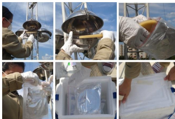
Figura 12. Recolección de la muestra disco PUF pasivo
