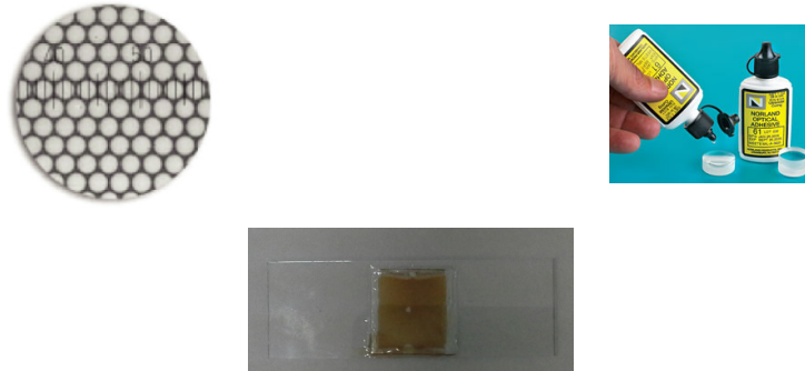
Figura 23. Imágenes de los espaciadores, el adhesivo y de la celda de vidrio para confinar los ferrofluidos.
