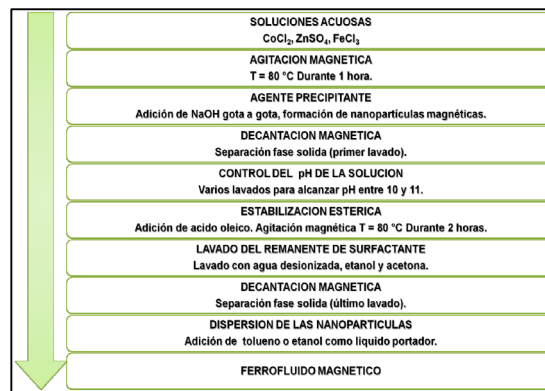
Figura 13. Diagrama de flujo para la síntesis del ferrofluido de Co_{(1-x)}Zn_xFe_2O_4
