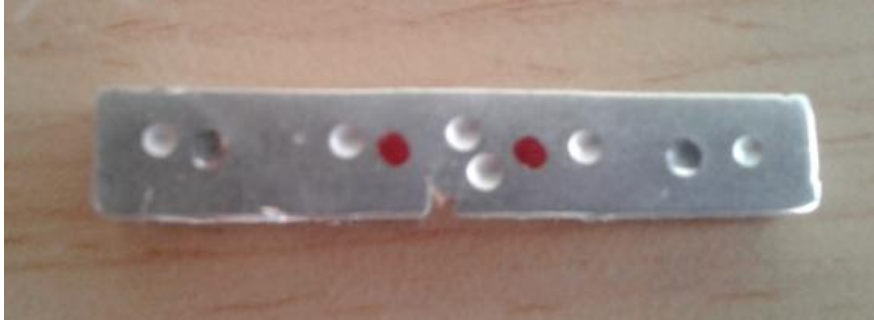
Figura 30. Puntos de toma de macrodureza en cada muestra
