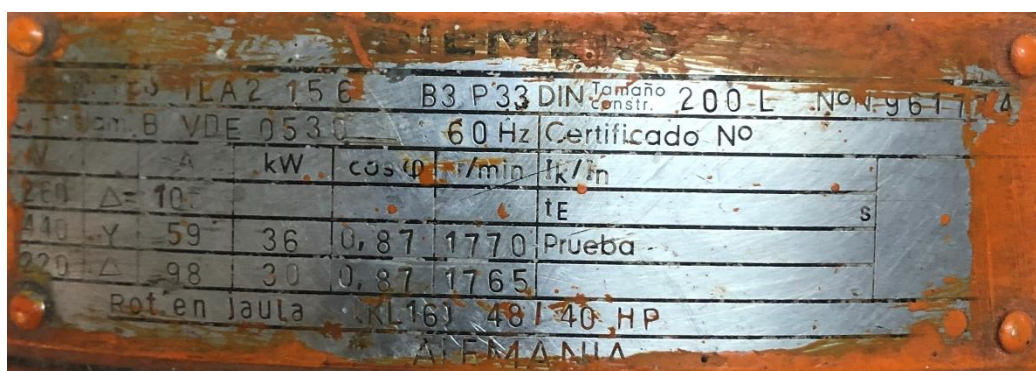
Figura 93. Placa característica motor lavado de estructuras.
