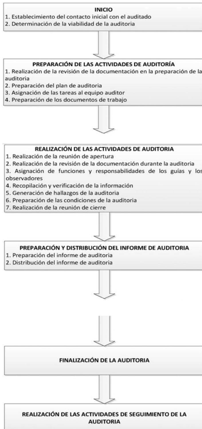
Figura 53. Procedimiento para realizar una auditoría interna al sistema de gestión de la energía (tomado de Metodología para la implementación del sistema de gestión integral de la energía. Fundamentos y casos prácticos.” 2014).
