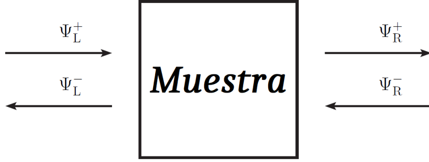
Figura 3.1: Las ondas incidentes \Psi_L^+(x) y \Psi_R^-(x) son dispersadas por la muestra. Las ondas salientes \Psi_L^-(x) y \Psi_R^+(x) consisten en ondas transmitidas a través de la muestra, así como ondas reflejadas en la muestra. Fuera de la muestra, la función de onda se puede expresar como una superposición de ondas planas.
