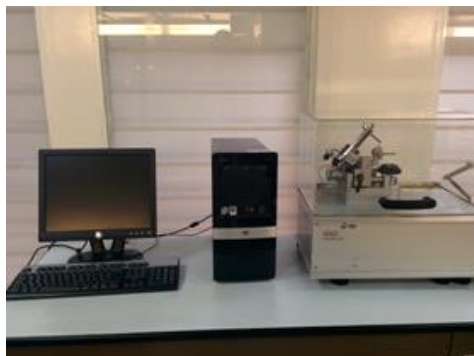
Figura 39 Tribómetro CSEM Instruments S.A. perteneciente al laboratorio RDAI. [10]
