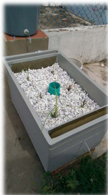
Figura 8. Fotografía del humedal construido utilizado en el experimento.
