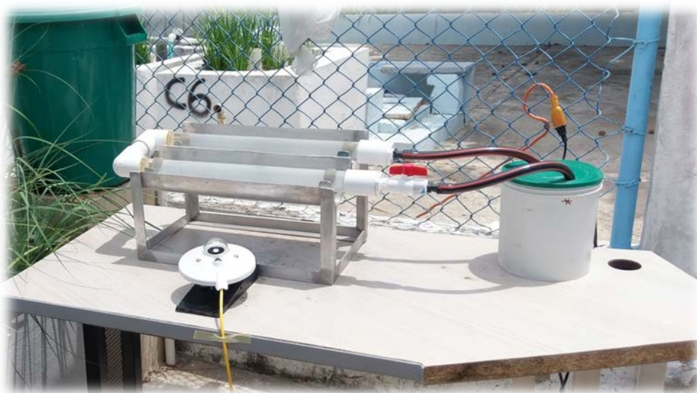
Figura 14. Fotografía del Fotorreactor solar usado durante la investigación
