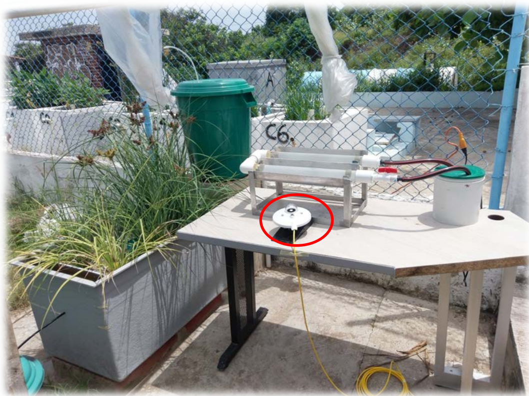
Figura 16. Acople tecnológico Humedal FSSH-Fotofenton solar. Encerrado en rojo, el radiómetro CUV5 (UV Kipp&Zonen)
