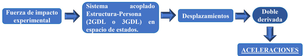
Figura 6.7. Modelo de subestructuración.
