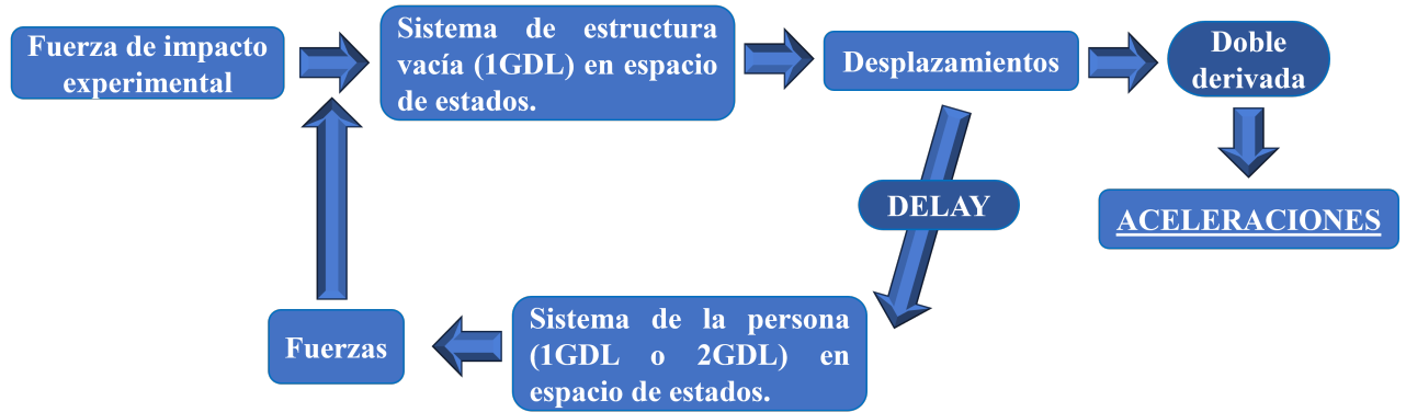
Figura 6.6. Modelo de subestructuración.
