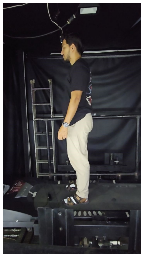
Figura 6.8. Ensayo de Simulación Híbrida en Tiempo Real (SHTR): Sujeto sobre la Plataforma Vibrante.
