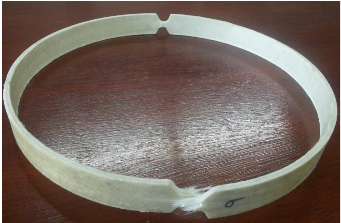
Figura 14. Fractura de una probeta ensayada a tensión circunferencial
