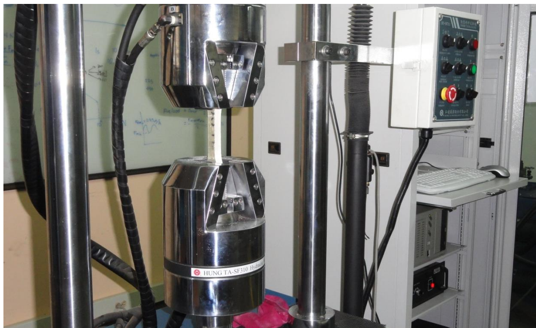
Figura 8. Máquina de ensayos estáticos y dinámicos HUNGTA, Laboratorio de ensayos dinámicos y materiales fibro-reforzados, Escuela de Ingeniería Mecánica, UNIVALLE
