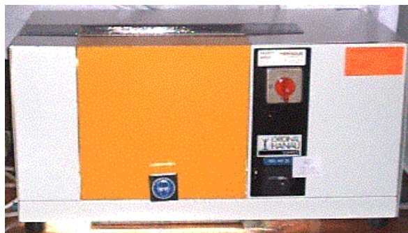
Figura 6. Equipo de radiación (suntest) empleado durante el pretratamiento con fotocátalisis
