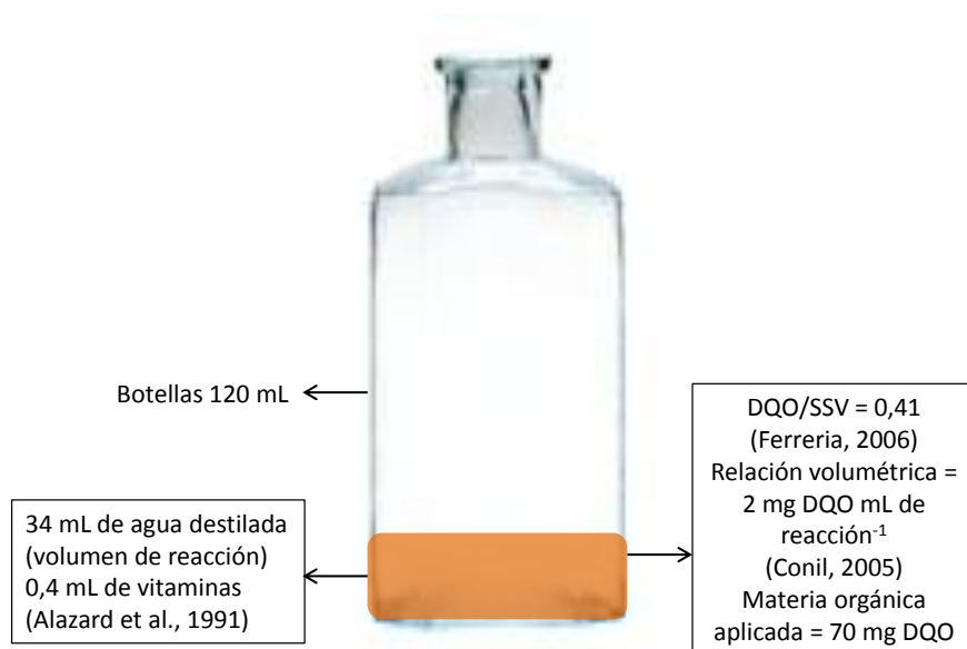
Figura 9. Descripción del montaje de las botellas para la producción de metano
