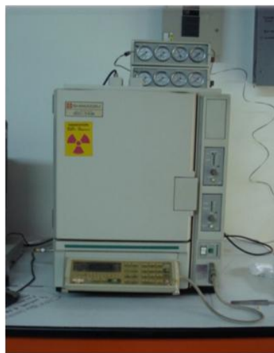
Figura 11. Cromatógrafo de gases Shimadzu GC-14 (Sistema de detección FID)
